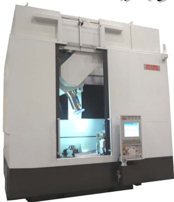
試作機 CNC立形複合研削盤 NVGH-9T
