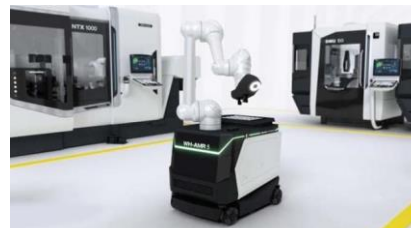
自律走行型ロボットによる自動搬送
